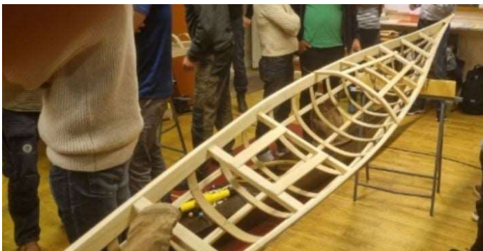
En kajaks träskelett färdigbyggt, bara ytan kvar. Clara basade och böjde ribbor på plats.
